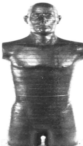
شکل ۹-۱: یک فانتوم انسانی (Alderson Rando Phantom) به صورت عرضی برای مطالعات دوزیمتری قسمت بندی شده است.
